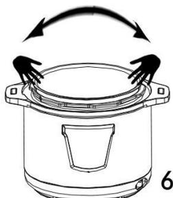
4. Antes de cerrar la tapa, asegúrese de que el anillo de silicona dentro de la tapa esté bien ensamblado. Gire la tapa en sentido contrario a las agujas del reloj y escuchará un sonido de palmada, lo que significa que la tapa está bloqueada. Ver Figura 7, 8 y 9.
