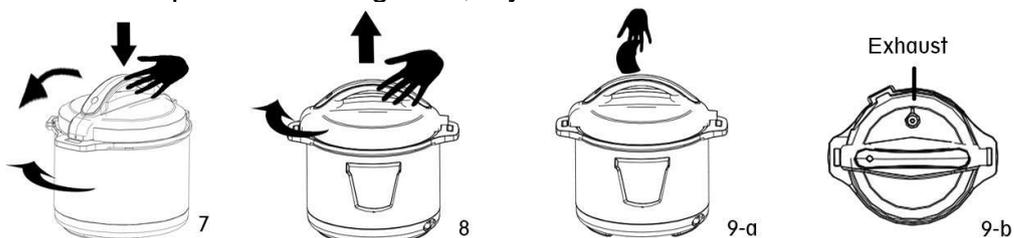
6. Después de cocinar, presione el botón cancelar para dejar de trabajar. Luego espere hasta que la válvula 2 caiga. O si desea abrirlo más rápido, puede poner un paño fresco y húmedo en la tapa para que se enfríe más rápido. Observación: cuando levante la válvula 1 para liberar aire a presión, debe hacerlo lentamente y tener cuidado.
