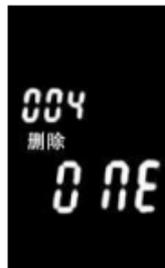
**Borrar todo:** En el modo de grabación en pausa / detenido, seleccione el archivo que desea eliminar, presione "M" y mantenga presionado para entrar al modo borrado. El display LCD muestra "ONE" luego pulse
